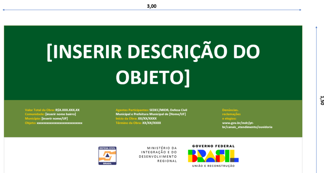
Fig.03: Ilustração da placa de obra e suas dimensões
