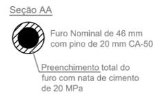
OBS: Os furos devem ser feitos com broca de 46mm ate chegar próxima a cota nominal de 3,0m de profundidade. Após feito o furo e colocado os pinos, deve ser preenchido com nata de cimento com fck = 20 MPa.
