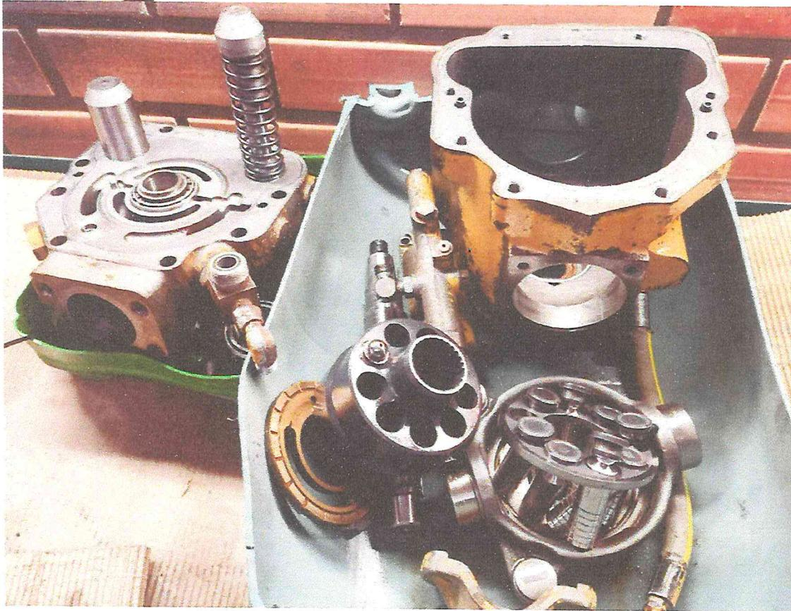
Figura 1 – BOMBA HIDRÁULICA MOTONIVELADORA
