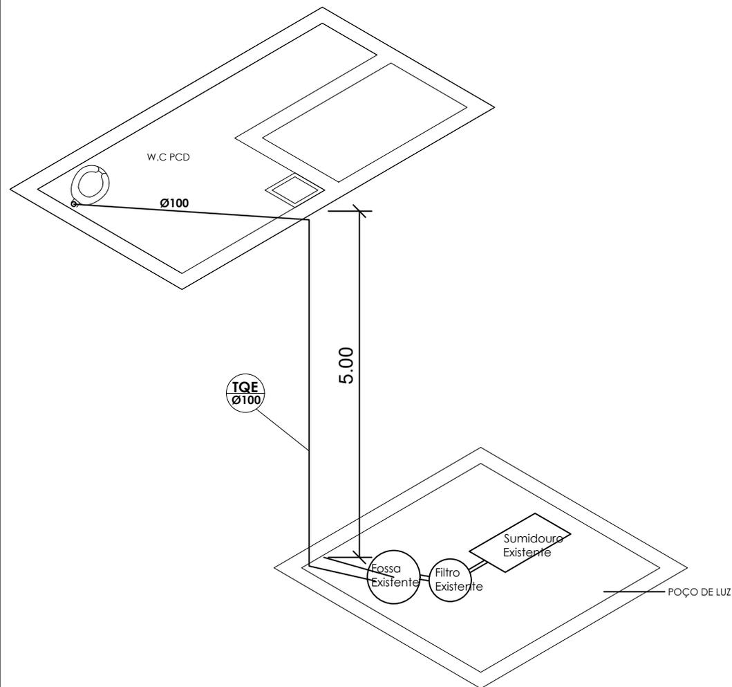
Perspectiva Isométrica de esquema sanitário do banheiro PCD
